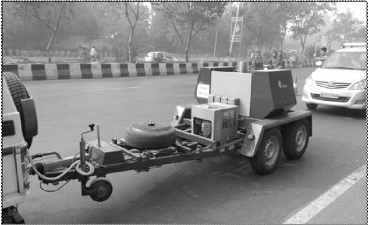
चित्र 2.12 अध्ययन सड़क पर कार्य प्रगति पर एफ.डब्ल्यू.डी. परीक्षण
