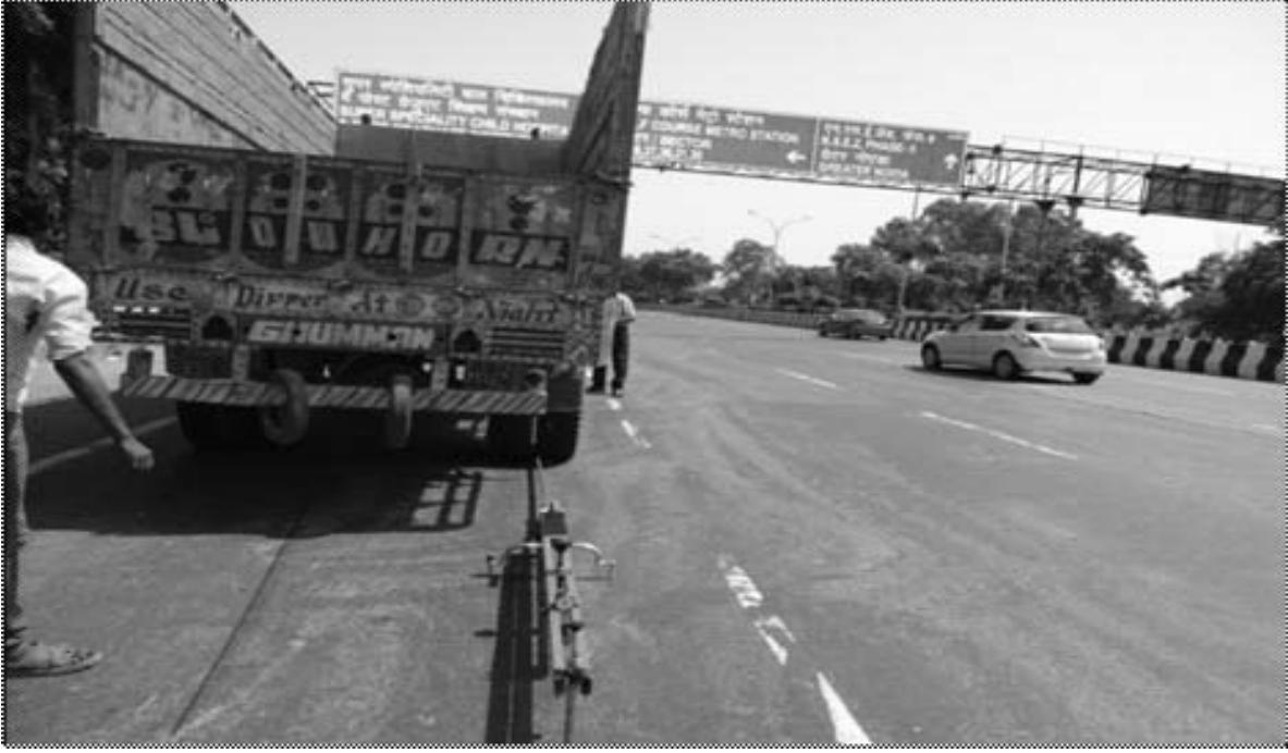
चित्र 2.11 बेन्केलमैन बीम विक्षेपन परीक्षण प्रगति पर
