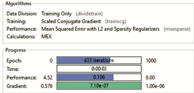
Fig. 10 —Autoencoder training parameters
